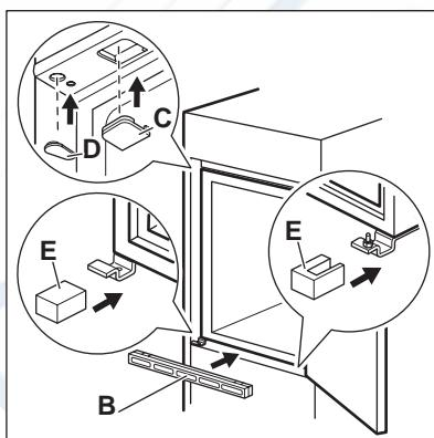
Установите крышки (C, D) в выемки и отверстия под петли.
