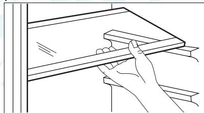
Чтобы обеспечить возможность хранения упаковок продуктов различных размеров, полки дверцы можно размещать на разной высоте. Для выполнения этой операции действуйте следующим образом: медленно потяните полку в направлении, указанном стрелками, пока она не освободится; затем установите ее на нужное место.
