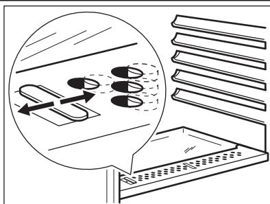
Стеклянная полка включает в себя устройство с пазами (регулируемыми специальным скользящим рычажком), позволяющее управлять влажностью в ящике (ящиках) для овощей.
