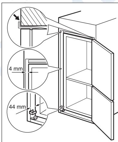
Отрегулируйте положение прибора внутри ниши.
