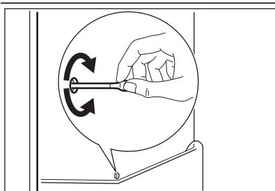
При нормальных условиях эксплуатации удаление льда с испарителя холодильной камеры происходит автоматически при каждом выключении компрессора. Талая вода стекает через сливное отверстие в специальный поддон, установленный с задней стороны прибора над компрессором, а затем испаряется. Необходимо регулярно прочищать сливное отверстие, находящееся в середине канала холодильного отделения, во избежание накопления воды и попадания капель на находящиеся внутри продукты.
