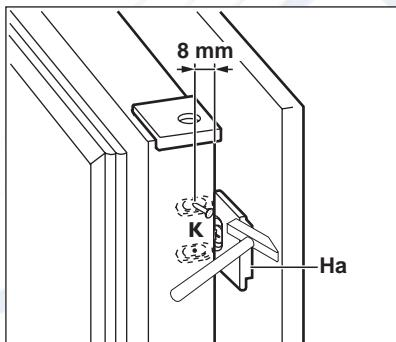
Снимите кронштейны и отметьте расстояние 8 мм от внешнего края дверцы: это место для гвоздя (K).
