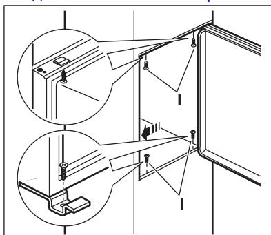
Закрепите прибор внутри ниши 4-мя винта-ми.
