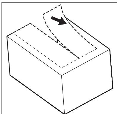
Удалите соответствующую деталь крышки петли (E). Если дверная петля находится справа, то следует удалить деталь DX; в противном случае удалите деталь SX.
