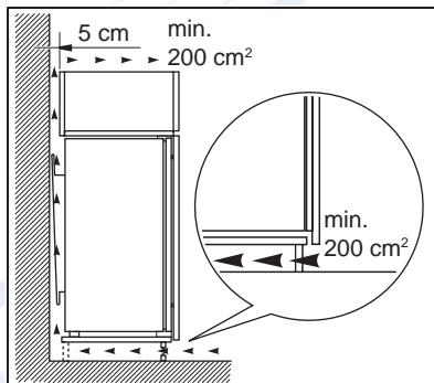
Необходимо обеспечить достаточную циркуляцию воздуха с задней стороны прибора.
